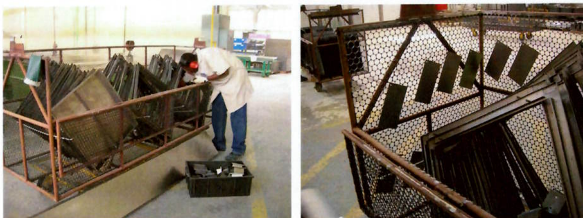
Figuras 6 e 7 – Disposição das peças para início do pré-tratamento com fosfato de zinco
