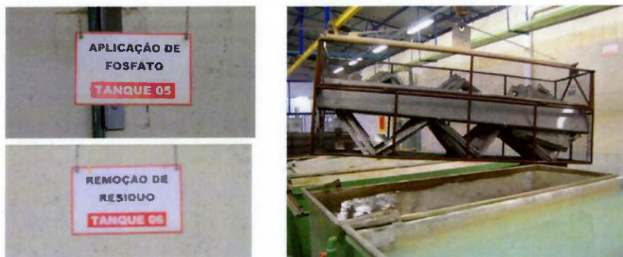
Figuras 16 e 17 Imersão das peças nos tanques 05 e 06: aplicação de fosfato e em seguida remoção de resíduos.
