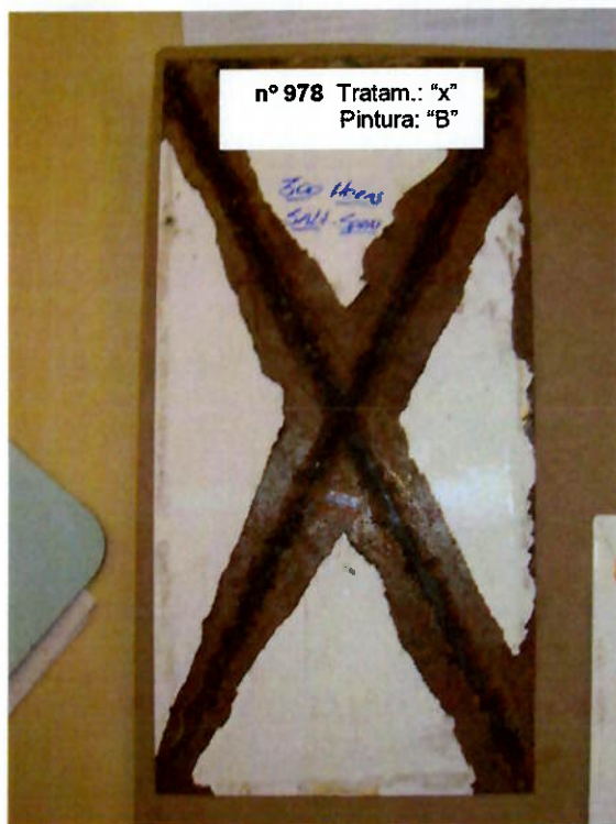
Figuras 27, 28, 29 e 30- Foto das placas 247, 135, 978 e 051 que foram submetidas ao teste de Névoa salina na empresa "T".
