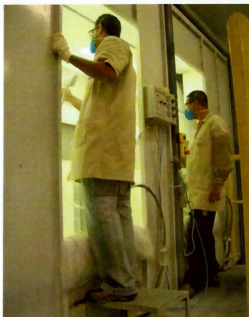
Figuras 24, 25 e 26 Cabine de pintura e vista da saída da estufa e da esteira da empresa “B”.
