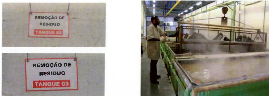
Figuras 11,12 e 13 Imersão das peças nos tanques 02 e 03 para remoção de resíduos da fase 1
