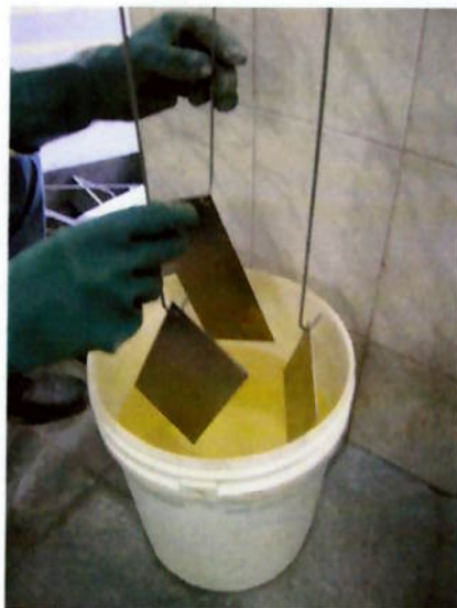
Figura 4 Período de escorrimento da solução
