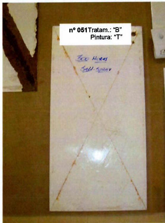
Figuras 27, 28, 29 e 30- Foto das placas 247, 135, 978 e 051 que foram submetidas ao teste de Névoa salina na empresa "T".
